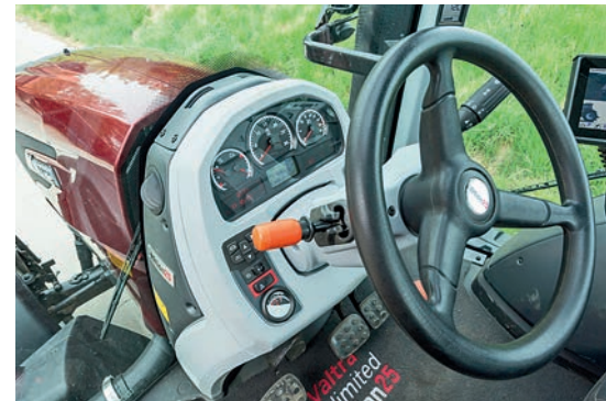
Das kleine Lenkrad kommt immer noch gut an. Der rastende Wendehelb „verträgt“ sich nicht mit der Wendeschaltung rechts.
