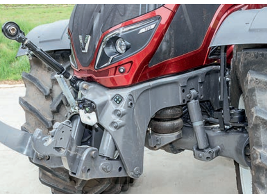
Die luftgefederte Vorderachse sorgt für exzellenten Fahrkomfort.
